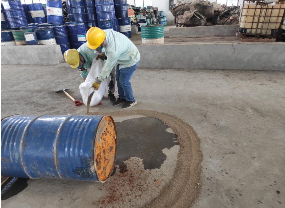
抢险组用砂土堵截、吸收泄漏物料
